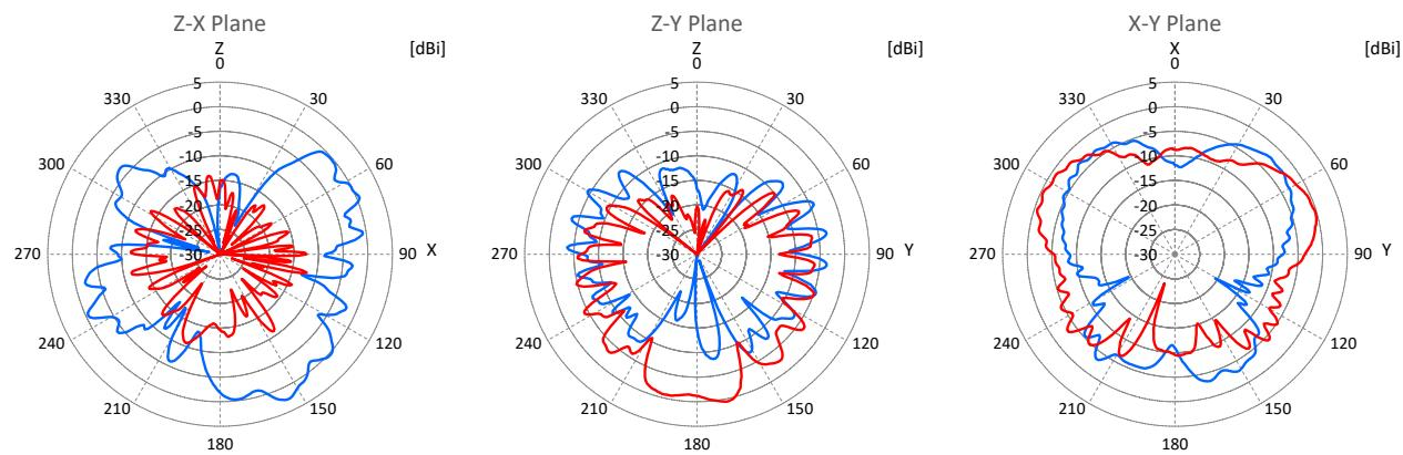
青線 Blue line: 水平偏波 Horizontal polarization
